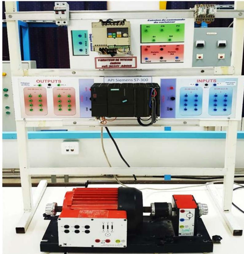
Figure 5. Photo réelle de la maquette de régulation de vitesse
