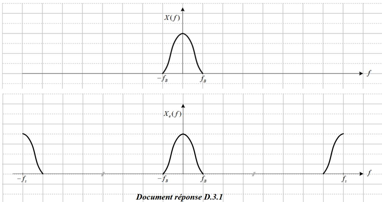
*On remarque que le sur-échantillonnage réduit la complexité du filtre anti-repliement.*
