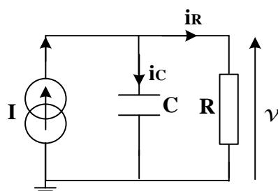
**C.1.1 Montrons que**  $V_I = \frac{S_d R}{1+jRC\omega} \emptyset_I$ .
